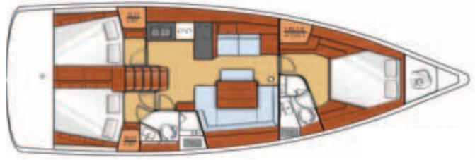
3 cabins - 2 heads / 3 cabines - 2 salles d'eau
